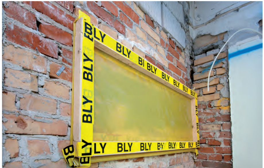
Der udtages prøve for kontrol af blyindhold i malingen
